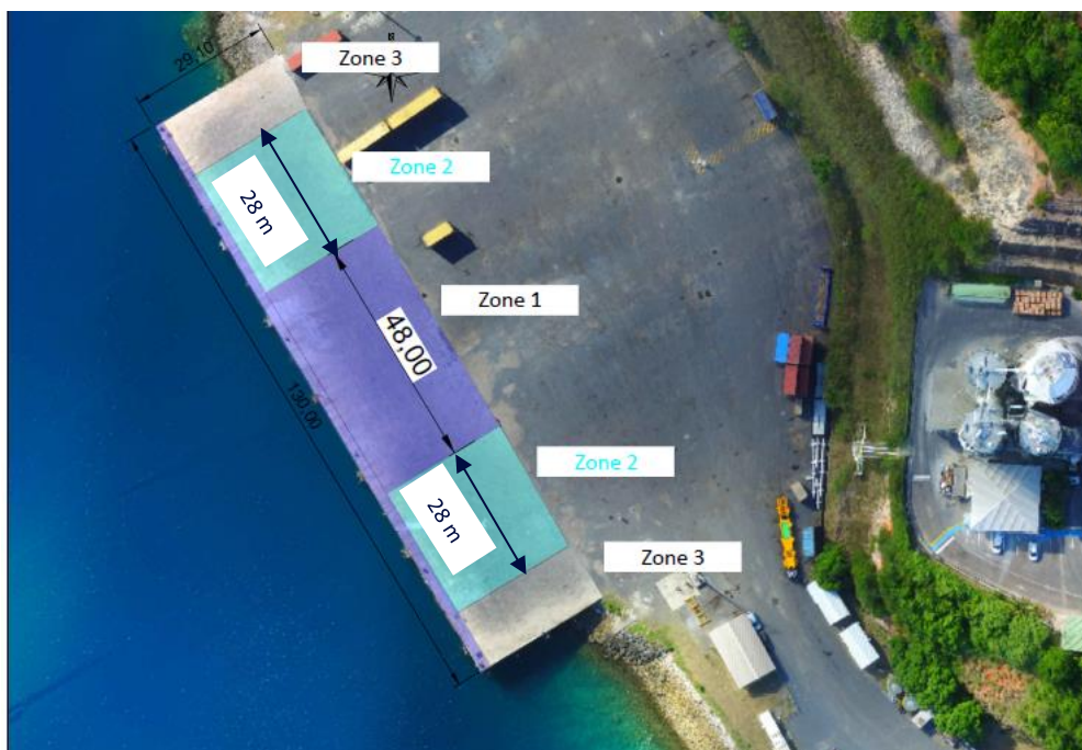
Figure 28: Plan de délimitation des trois zones de priorité de réalisation des travaux de la plateforme (source : SAFEGE 2020)
