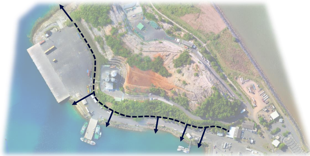
Figure 13 : Tracé et exutoires du caniveau
