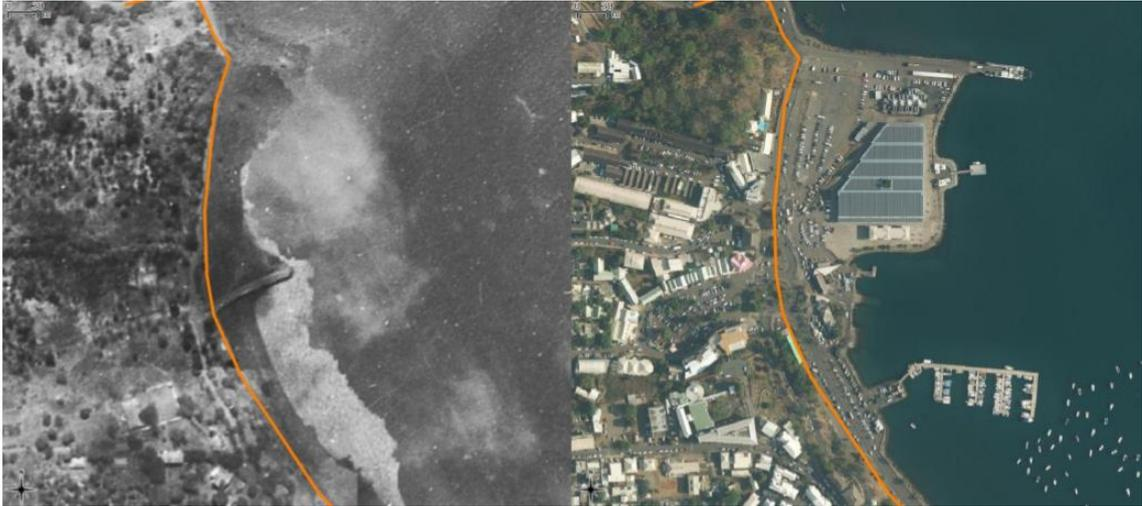
Figure 10 : Remblaiement du quai des douanes (à gauche BD Ortho historique IGN 1950, à droite BD Ortho HR 2016, source : CEREMA 2017)
