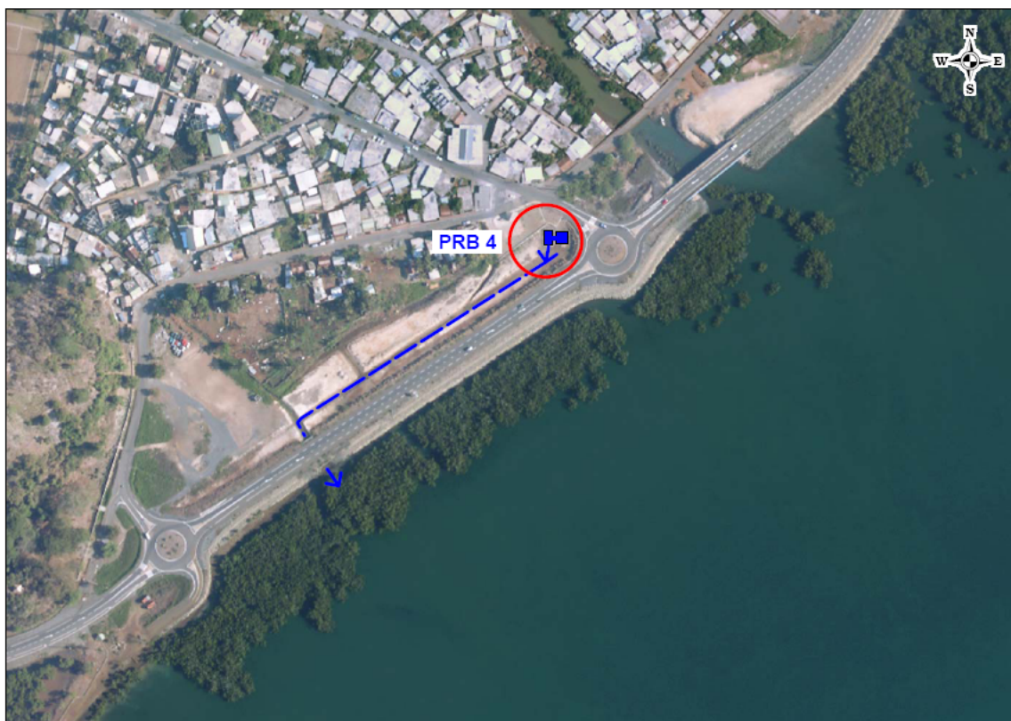
Localisation du point de rejet du trop plein du poste PRB4 de Passamainty et emplacement possible pour la création d'un bassin de rétention ou d'une noue végétalisée
